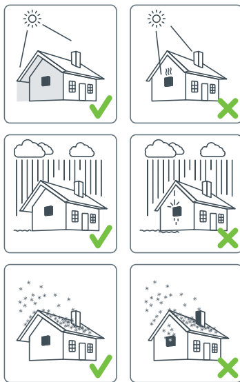
Рисунок 3.4.1 Правила расположения инвертора на фасаде здания
